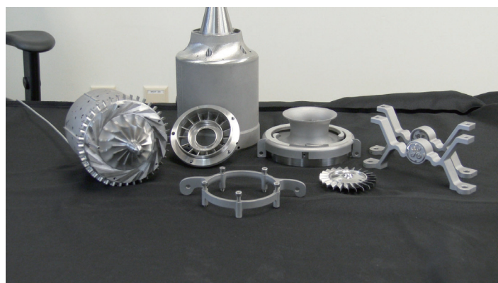
图2 通用航空利用粉末增材制造技术制造微缩发动机原型的所有部件 Fig.2 Additive manufactured parts of the little engine by GE Aviation
